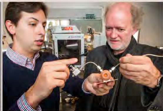
Leander Michels (til venstre) og Jon Otto Fossum. En leireprøve legges i det lille kammeret de holder. Ved hjelp av røntgenstråler kan de måle om leiren har tatt opp CO 2 . Foto: Per Harald Olsen, NTNU
